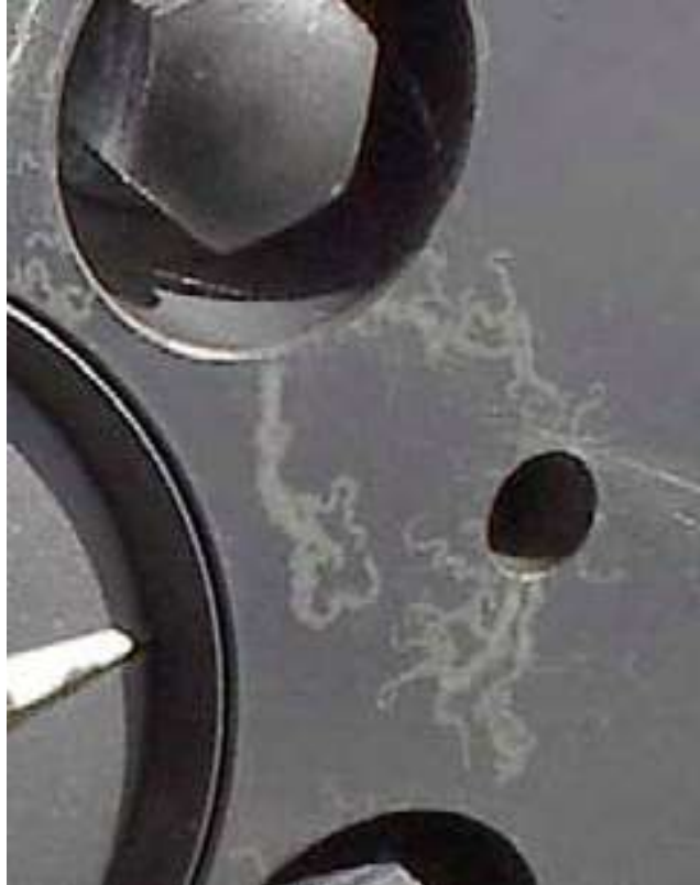
Filiformkorrosion an Aluminiumrädern, ausgehend von Kanten bzw. Verletzungen
